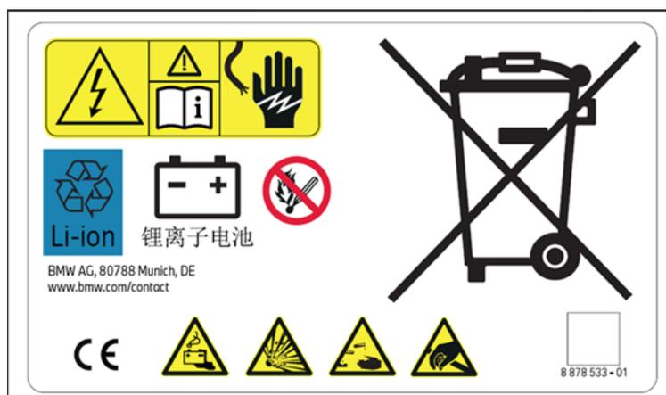
Primjer: Simbol za recikliranje "Li-ion" na visokonaponskoj bateriji
